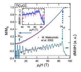
使用单匝技术对 TICuCl<sub>3</sub> 在 100T 范围内的整个磁化过程进行了研究。在 2K 下观察到上临界场为86.1T。在下临界场和上临界场之间清晰观察到M-H 曲
